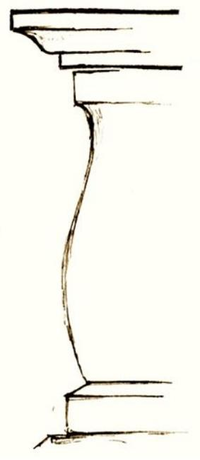
De plan carré, il est plutôt élancé et repose sur une petite dalle en partie cachée. À sa base, existe une plinthe, chanfreinée sur le haut. Encore bien visible sur des clichés de 1984, cette base est aujourd'hui en partie recouverte par les terres.
