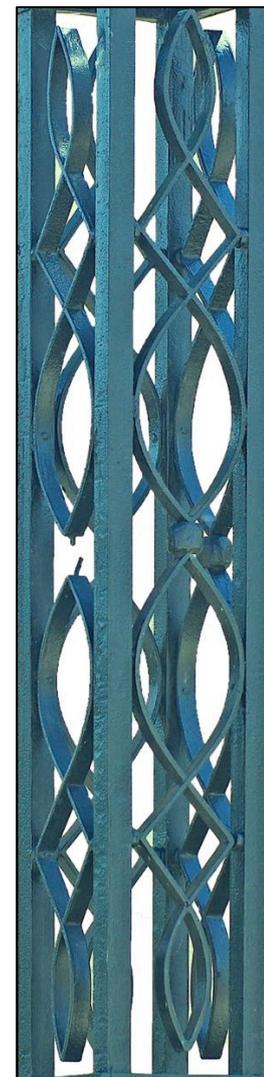
Prolongeant le tabouret carrossé, le fût-colonne 3D vise à donner de la hauteur au monument (s'élever vers le Ciel). Quatre fers structurels de section carrée forment les arrêtes de cette structure élancée. Le fût-colonne est ceinturé en haut par un collier à baguette torique. Un chapiteau carrossé coiffe le fût avant de recevoir le croisillon bidimensionnel.
