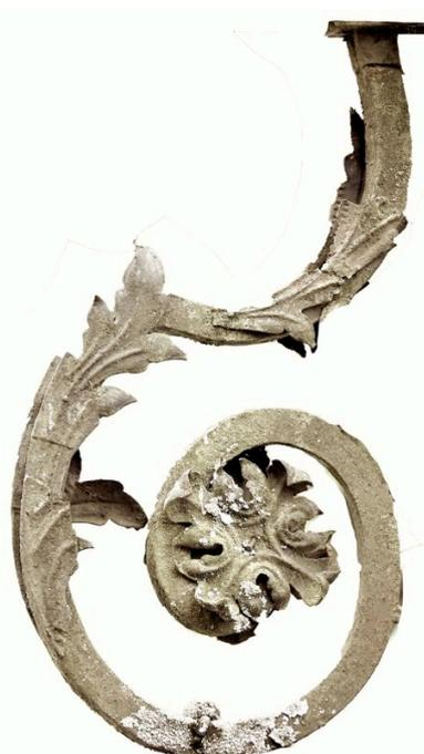
À noter les décors en tôle de fer couvrant en partie les consoles ainsi que des fleurs à quatre pétales en tôle estampée couvrant le noyau des rouleaux bas et s'y fixant.
