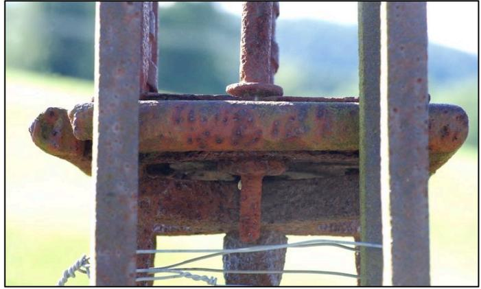
Après leur mouvement spiralé, les fers de section carrée des rouleaux changent de courbure et se redressent verticalement pour venir se fixer sur un dispositif d'entretoisement. Les fers des rouleaux sont soudés à cette entretoise en forme de X.
